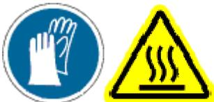
Utilize luvas resistentes ao calor quando utilizar o Mini-Ductor® II+. O Mini-Ductor® II+ aquece metal muito rapidamente. Pode queimar as mãos e dedos quando tentar retirar peças de superfícies de metal quentes.
