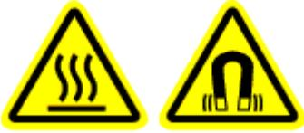
Quitar cualquier moneda, distintivo metálico, llave, cadena, navaja, herramienta en miniatura u otro objeto metálico suelto que lleve en sus prendas antes de usar el Mini-Ductor® II. No vuelva a utilizar estos elementos hasta tanto no haya terminado de usar el Mini-Ductor® II. El Mini-Ductor® II puede calentar estos objetos metálicos muy rápido y ocasionar quemaduras serias o incluso hacer arder la ropa.
